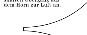
Abb. 4. Dieser Trichter ist ebenso gut, wie der nach Abb. 3, er streut aber den Schall etwas weiter auseinander.
